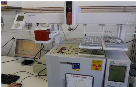
slika 2: Gasni hromatograf sa plameno - jonizujućim detektorom i headspace autosemplerom
